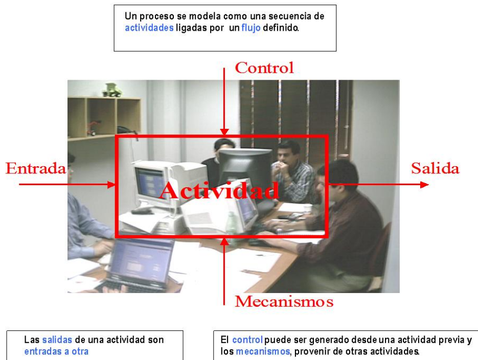
Figura 2: Módulo Básico de Modelamiento de Procesos
